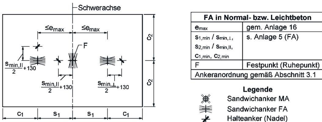
PHILIPP Sandwichanker MA und FA zur Verankerung von Vorsatzschalen an Tragschichten
